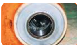
การพับเคลือบ WC ด้วยเปลวความร้อน
