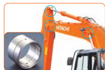
การพับเคลือบ WC ด้วยเปลวความร้อน
